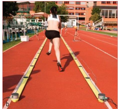
Figure 20 : Système de détection optique placé sur un tapis roulant. (a) ou en série sur le sol (b) permettant l'analyse spatio-temporelle de la marche et de la course Type Optojump Next®, d'après optojump.com.
