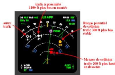
(Electronic Flight Information System) en particulier sur le ND (Nav Display) (voir Fig. 518).
