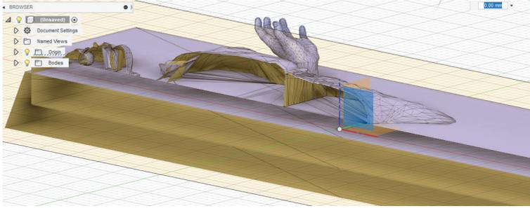
Fusion 360 et Autodesk HSM peuvent réussir à comprendre les peaux et à les usiner telles quelles. Lors du setup, il faudra bien indiquer le sens de la fraiseuse de manière pertinente. Définir les zones à éviter et les zones à travailler lors de la sélection des chemins d'usinage sera complexe. C'est pourquoi nous vous conseillons de préférer les fichiers natifs ou les fichiers volumiques (.igs et .stp) lors de vos échanges.
