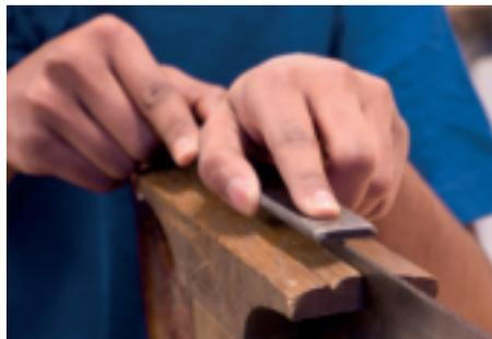
**1 Pincez fermement la lame** de la scie dans un étau, les dents vers le haut. Nivelez la surface de la denture.
