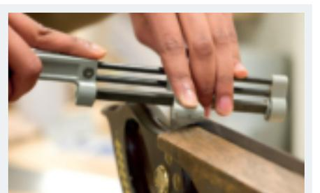
**SCIE À TRONÇONNER** : procédez comme en 1, 2 et 3 ci-dessus puis affûtez les dents avec une lime spéciale placée dans un gabarit qui permet de limer simultanément à l'angle voulu les bords de deux dents adjacentes. Répétez sur l'autre côté.
