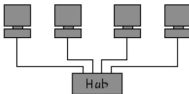
En revanche, un réseau à topologie en étoile est plus onéreux qu'un réseau à topologie en bus car un matériel supplémentaire est nécessaire (le concentrateur).
