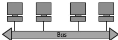
Une **topologie en bus** est l'organisation la plus simple d'un réseau. En effet, dans une topologie en bus tous les ordinateurs sont reliés à une même ligne de transmission par l'intermédiaire de câbles, généralement de type coaxial. Le mot « bus » désigne la ligne physique qui relie les machines du réseau.
