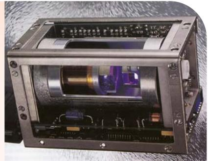
Les horloges atomiques présentes dans les satellites sont à la base du GPS.
