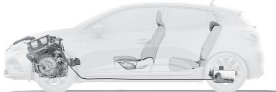
Renault Clio e-tech Hybrid et sa batterie 230V 1,2 kWh
