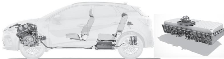
Renault Captur e-tech Hybrid rechargeable et sa batterie 400V 9,8 kWh
