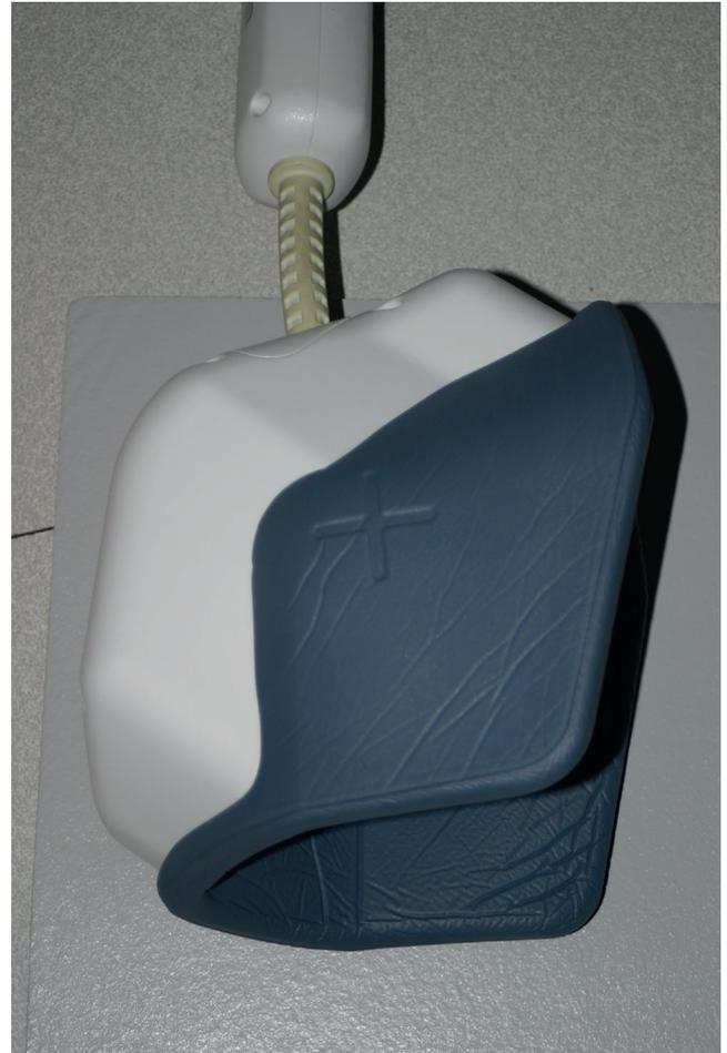
Figure 7.2. Antenne coque réseau phasé.
