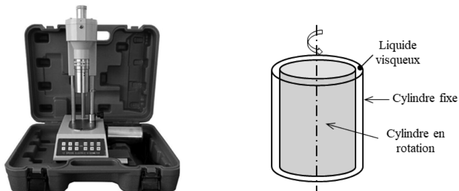
Figure 1.5 Viscosimètre rotatif à cylindres coaxiaux
