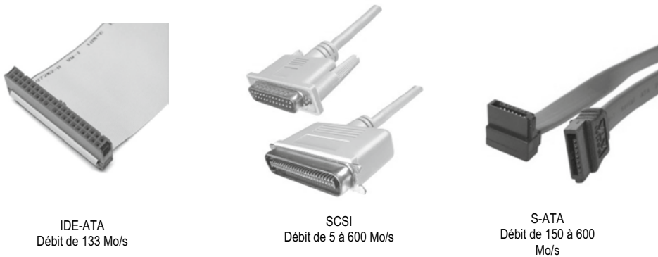
Figure 1.3 – Différentes interfaces de disques durs, avec leur débit théorique.
