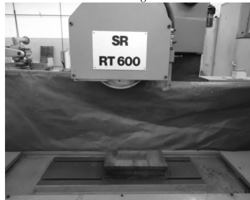
Un des procédés d'usinage par abrasion : la rectification
