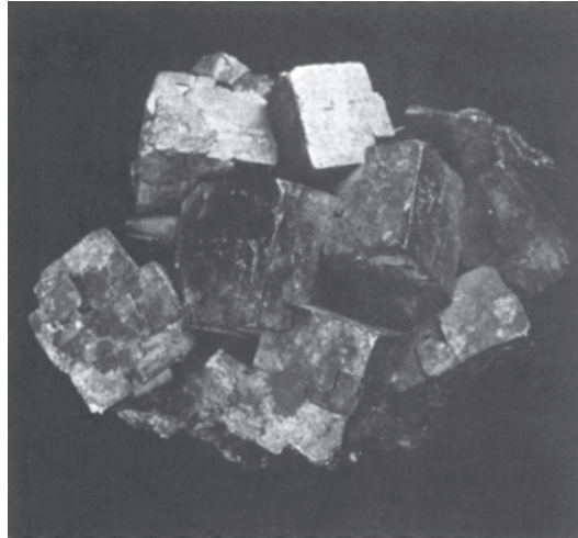
Figure 17 Cristaux naturels de sulfure de plomb, PbS, qui possède la structure cristalline de NaCl (photographie de B. BURLISON).
