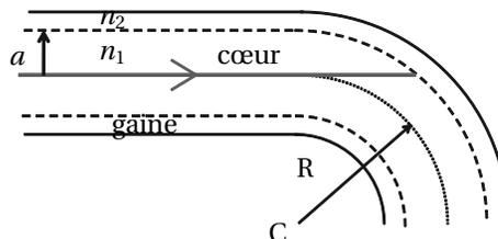
Pour déterminer un ordre de grandeur de la courbure acceptable par une fibre à saut d'indice, on envisage un rayon confondu avec l'axe du cœur dans la partie rectiligne de la fibre.
