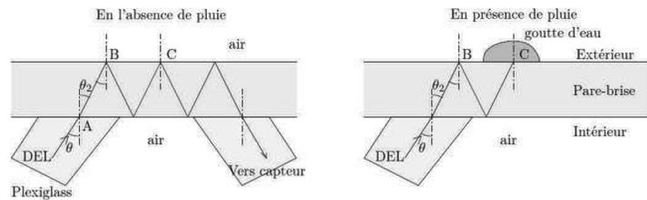
Les rayons lumineux émis par la diode se propagent jusqu'au pare-brise dans du plexiglas d'indice optique  $n_p = 1,50$ . Les rayons sont dirigés vers le pare-brise avec un angle d'incidence de  $\theta = 50^\circ$ . On supposera que le pare-brise est en verre d'indice optique  $n_v = 1,55$ . L'indice optique de l'eau est  $n_e = 1,33$  et celui de l'air est  $n_a = 1,00$ .
