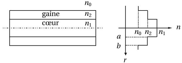
La transmission s'effectue par réflexion totale sur la gaine des rayons à l'intérieur du cœur.
