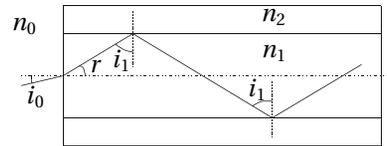
Cela se traduit par un angle  $i_0$  à l'entrée dans la fibre appelé *angle d'acceptance* tel que  $n_0 \sin i_0 = n_1 \sin r = n_1 \sin \left( \frac{\pi}{2} - i_1 \right) = n_1 \cos i_1$ .
