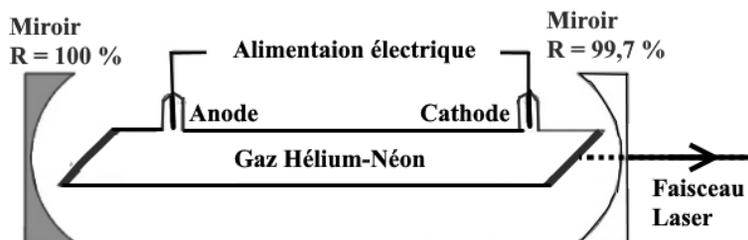
Fig. 1.1 – Schéma de principe d'un Laser Hélium-Néon
