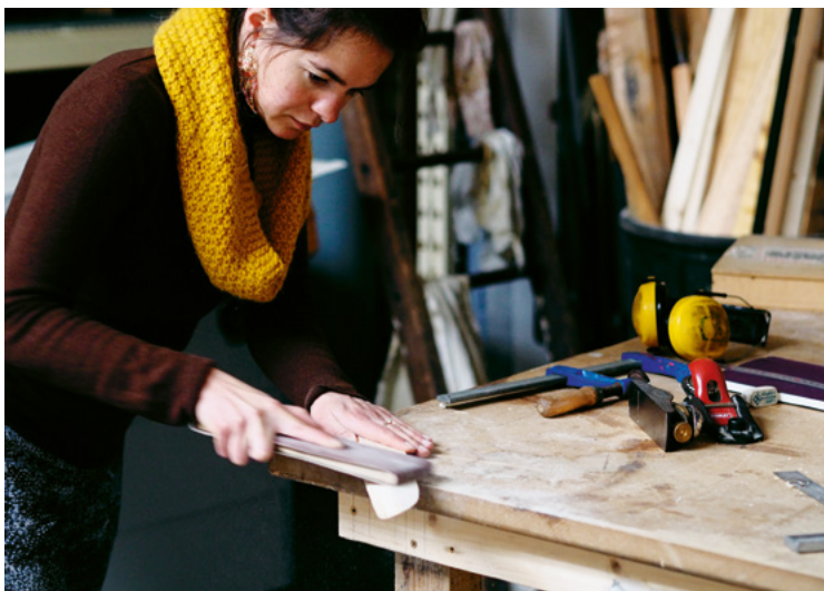
Réalisation du profil et ponçage des pales.
