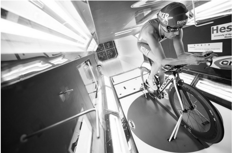
FIGURE 1.3 – Essais en soufflerie de jantes MAVIC. Avec l’aimable autorisation de la soufflerie HEPIA Genève, de MAVIC et de cinemargot.com.
