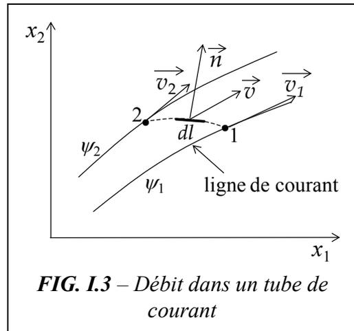
**FIG. I.3** – Débit dans un tube de courant
