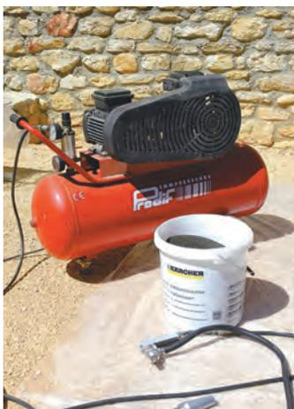
**1** Le décapage nécessite un **compresseur à air avec un pistolet de sablage** et du sable spécial. Ce type d'équipement est proposé en location.
