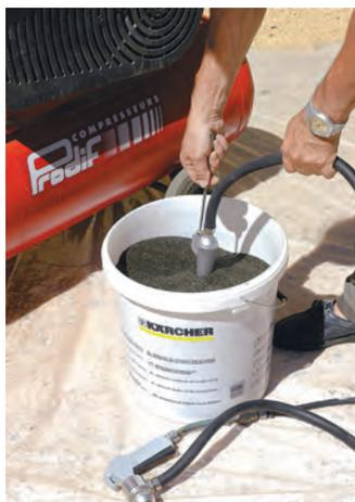
**2** Enfoncez la **crépine** du pistolet dans le sable. Les grains de silice seront aspirés par dépression.
