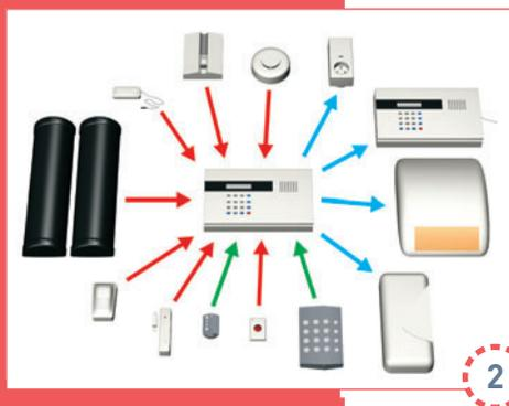
Les détecteurs (flèches rouges) repèrent l'intrusion (effraction ou tentative d'effraction) puis envoient l'information à la centrale, le « cerveau » du système. Celle-ci analyse l'information, puis déclenche les avertisseurs (flèches bleues) et éventuellement un service de télésurveillance par le biais d'un transmetteur téléphonique.
