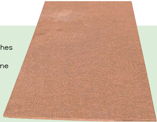
Panneau de fibres dures, plus connu sous le nom de son fabricant: Isorel
