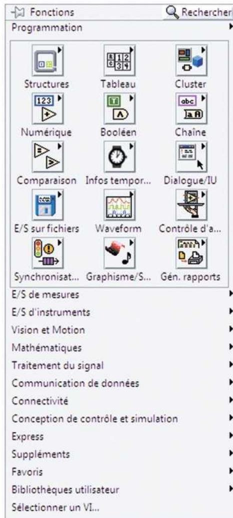
Figure 1.13 (b) – Palette de programmation des fonctions disponibles dans la fenêtre « Diagramme ».
