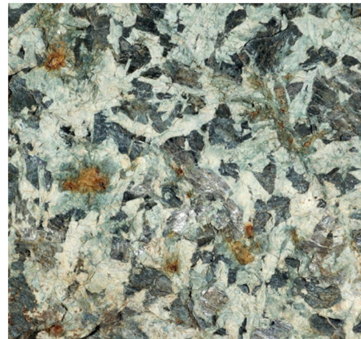
*Gabbro des Aiguilles Rouges d'Arolla présentant des altérations secondaires (décoloration verdâtre du plagioclase, oxydation corrosive autour des minéraux métalliques, diallagisation de l'augite).*
