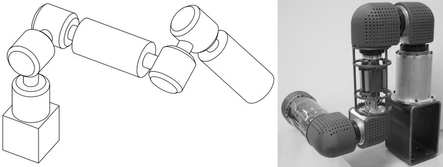
FIGURE 1.2. Robot sériel à 5 degrés de liberté développé au laboratoire de robotique de l'université Laval pour l'interaction physique humain-robot [2].
