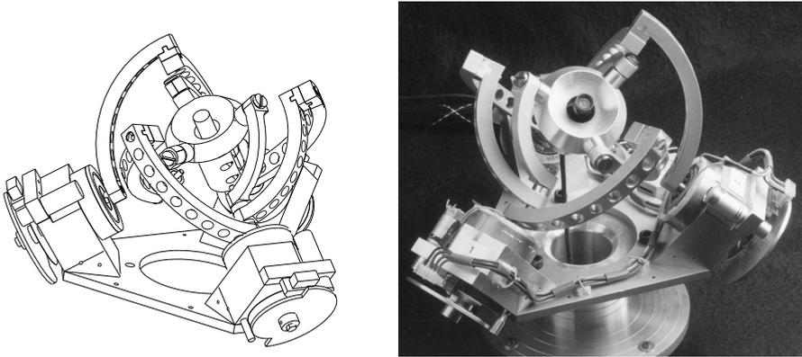
FIGURE 1.8. L'œil agile, un robot parallèle sphérique à trois degrés de liberté développé au laboratoire de robotique de l'université Laval pour l'orientation rapide d'une caméra [11].
