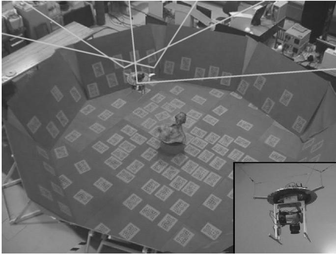
FIGURE 1.6. Robot parallèle entraîné par câbles développé au laboratoire de robotique de l'université Laval [9].
