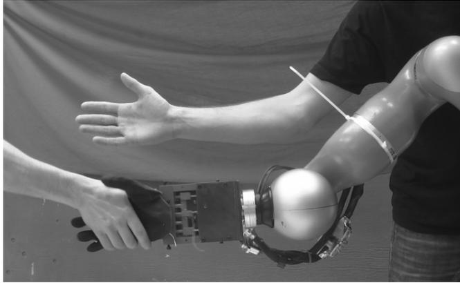
FIGURE 1.7. Dispositif robotique développé au laboratoire de robotique de l'université Laval pour émuler une poignée de main [10].
