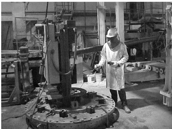
Figure 1.3 – Traitement d'un bain d'alliage d'aluminium et contrôle de la température avec une canne pyrométrique (Fonderie Honsel-Messier).
