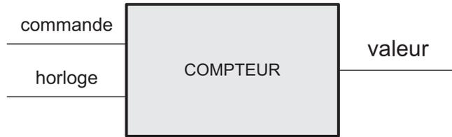
Figure 1.12 – Système séquentiel
