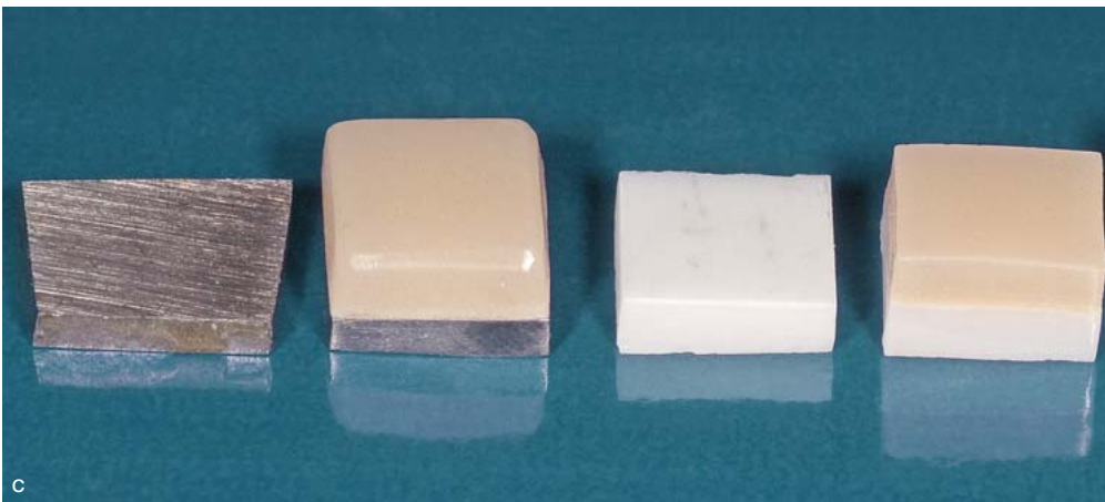
Abb. 8-3c und d Im Vorfeld der Untersuchungen wurden Probekörper aus Titan, keramisch verblendetem Titan, Zirkoniumdioxidkeramik und keramisch verblendeter Zirkoniumdioxidkeramik hergestellt (c). Zur Durchführung der spektralfotometrischen Messungen wurden die verschiedenen Probekörper unter die Schleimhaut gelegt und die Farbveränderungen bei unterschiedlichen Weichgewebisdicken miteinander verglichen (d) 7 .
