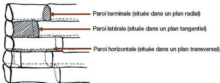
■ Figure 1.2. Représentation schématique d'un rayon ligneux unisériel de résineux à l'échelle microscopique. Les parois terminales et horizontales, communes à deux cellules de parenchyme radial contiguës, portent des punctuations simples (non représentées ici). Les parois latérales, communes à une cellule de parenchyme radial et une trachéide longitudinale, portent des punctuations semi-aréolées, dites punctuations de champ de croisement (non représentées ici).
