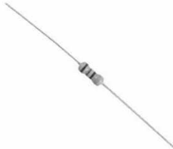
Figure 2.13 Résistance à couche de carbone.
