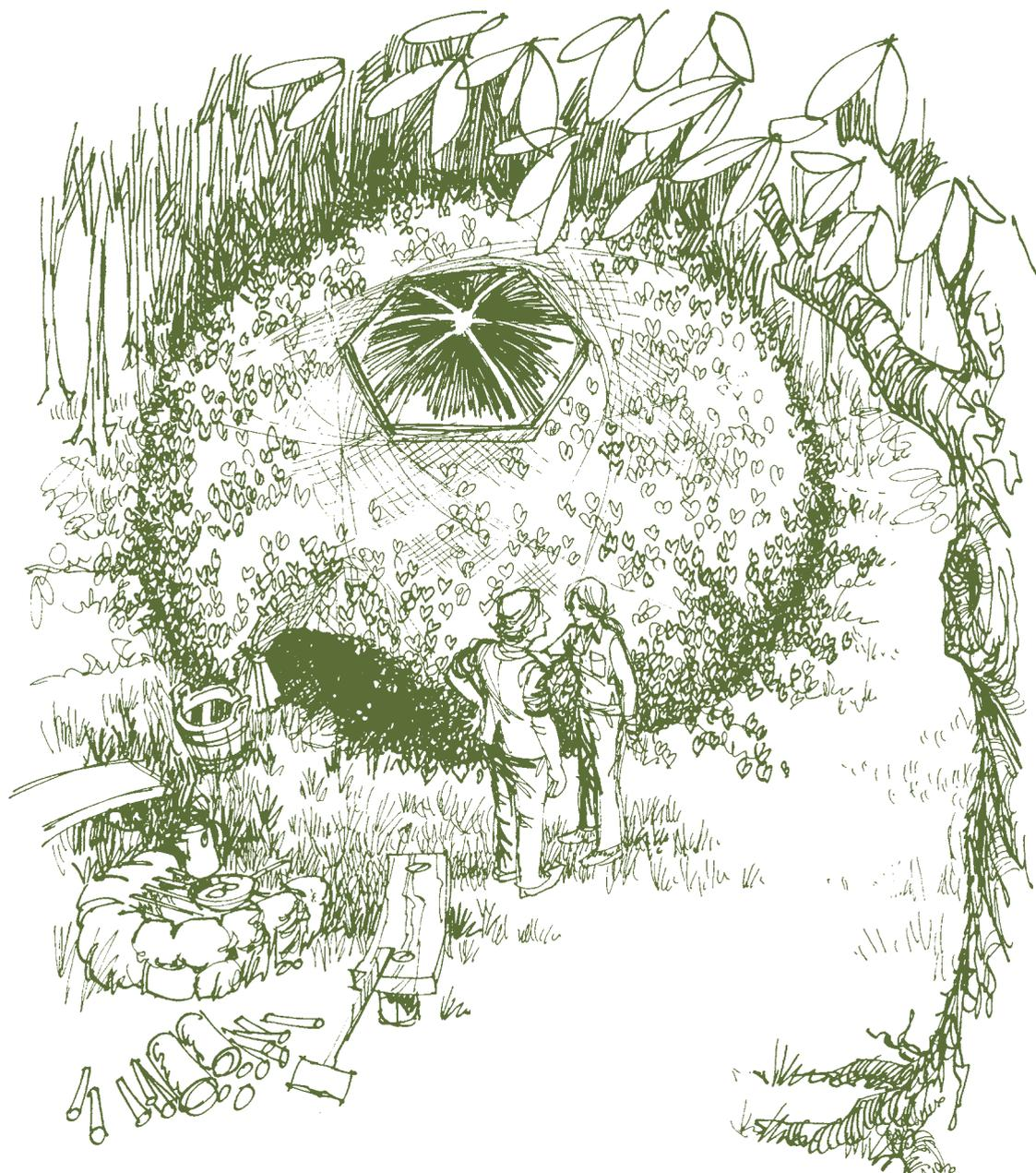
Avec sa structure portante faite de fines lattes arquées et reliées ensemble, recouverte de toile de parachute en nylon et de fil de fer, puis végétalisée avec du lierre, de la vigne vierge, des clématites ou toute autre plante grimpante à croissance rapide, cette cabane peut être
