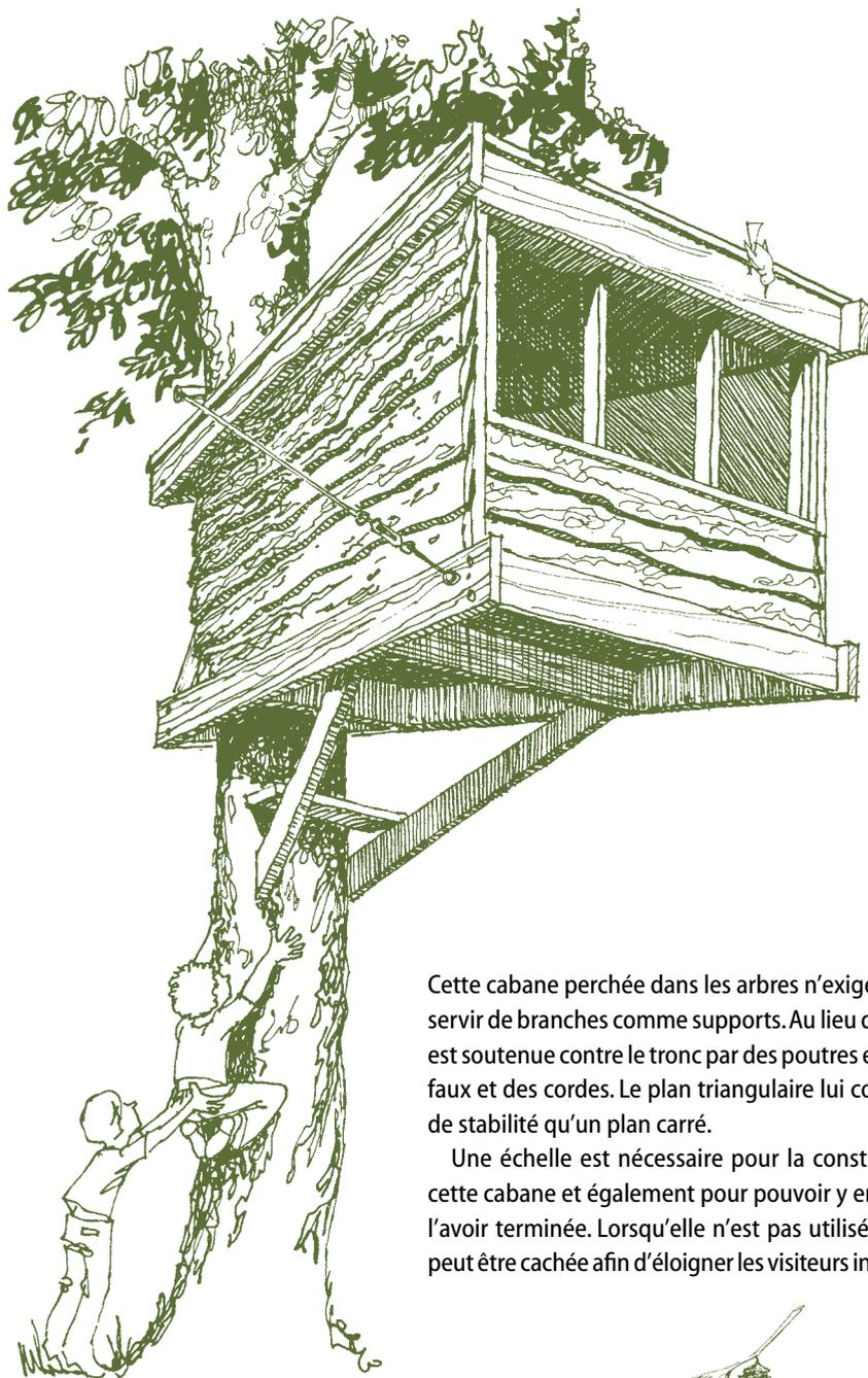
Cette cabane perchée dans les arbres n'exige pas de se servir de branches comme supports. Au lieu de cela, elle est soutenue contre le tronc par des poutres en porte-à-faux et des cordes. Le plan triangulaire lui confère plus de stabilité qu'un plan carré.
